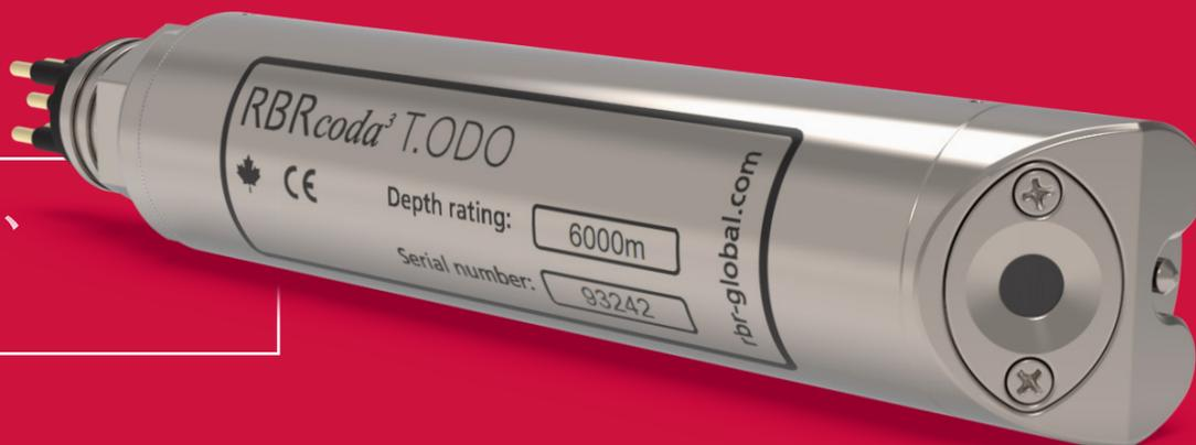
RBRcoda<sup>3</sup> T.ODO是一种高精度、低功耗的光学传感器。快速型|fast传感器的时间常数仅为1秒，非常适合用于剖面观测。慢速型|slow的传感器光学箔片上具有一层保护层，可以配置防生物附着刷来清洁生物附着，从而适用于长期锚系观测。
