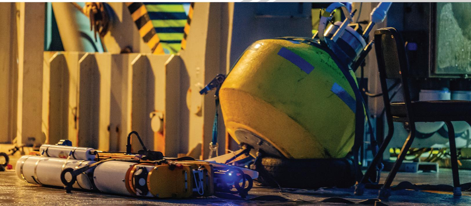
RBRcervello数据采集控制器安装在Del Mar Oceanographic (DMO) WIREWALKER™的海面浮标上。来控制 and 接收安装在 WIREWALKER™上的RBRconcerto<sup>3</sup>或RBRmaestro<sup>3</sup>通过感应耦合传输的数据。并通过GSM或铱星将数据进行实时传送，数据可以立即从自己的网站上进行查看和获取。数据同时也可以备份保存在RBRcervello上，在进行后期系统维护的时候用U盘拷出。
