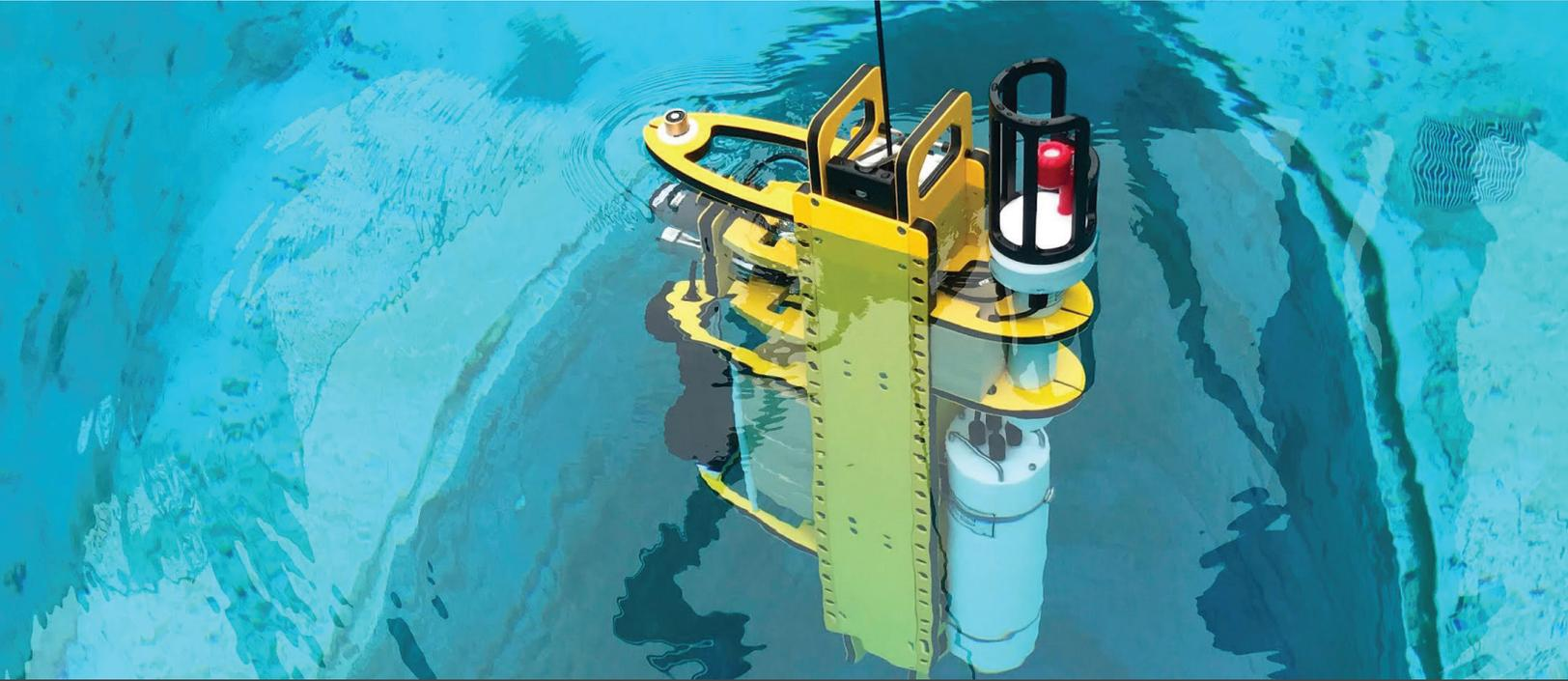
RBR很高兴为您提供Del Mar Oceanographic (DMO)公司研发的WIREWALKER™, 这是一款依靠波浪动力、全机械构造、集传感器和数采通信系统为一体的剖面观测系统。DMO公司的WIREWALKER™可以配置搭载RBR*concerto*<sup>3</sup>或RBR*maestro*<sup>3</sup>仪器。还可以选配RBR*fermata*电池仓, 延长部署周期达40倍, 并可为无线远程数据传输供电。
